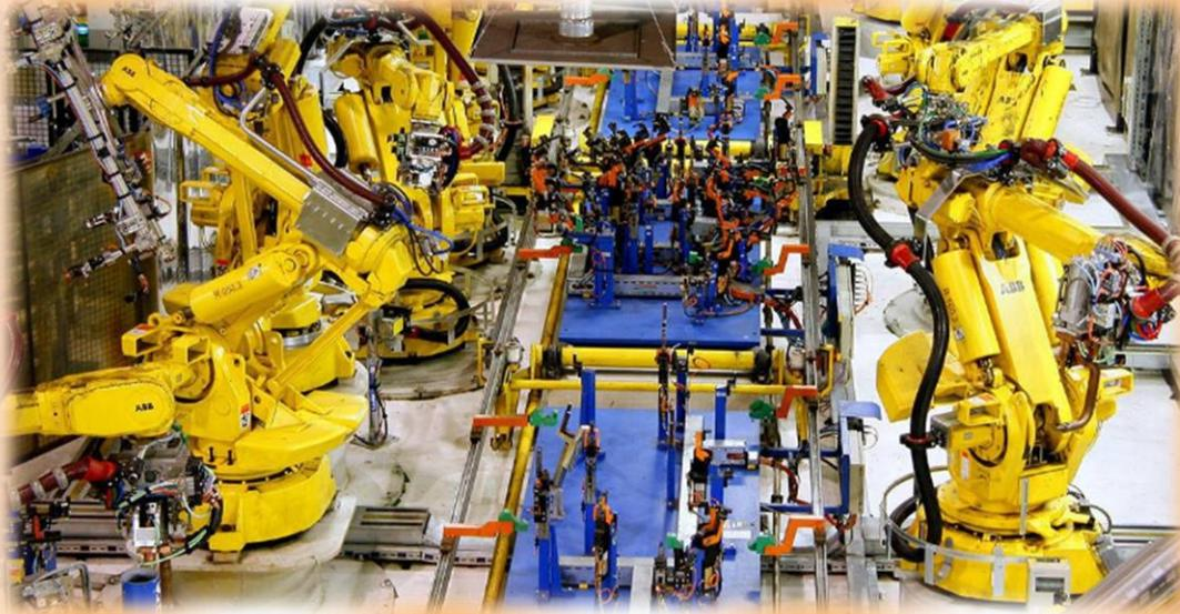
La carrocería de un coche contiene miles de puntos de soldadura. Controlarlos al máximo, mejorando la calidad de los procesos vinculados a la fijación de piezas para tratar de predecir posibles averías, es un desafío para cualquier fábrica de automóviles.
